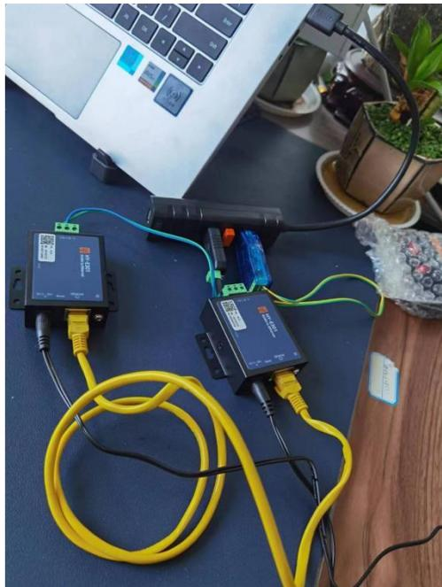
四、串口测试；打开串口助手工具，分别选择串口服务器 A 和串口服务器 B 的串口号（usb 转 485 接到电脑上会生成一个 comX 的串口号）
