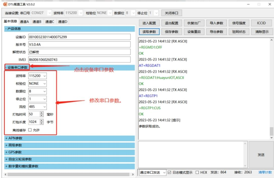
7. 配置DTU的工作模式为云平台透传模式。（若DTU配置工具中通道A不支持该模式或配置错误，请确认《DTU配置工具》版本和DTU设备固件版本）。
